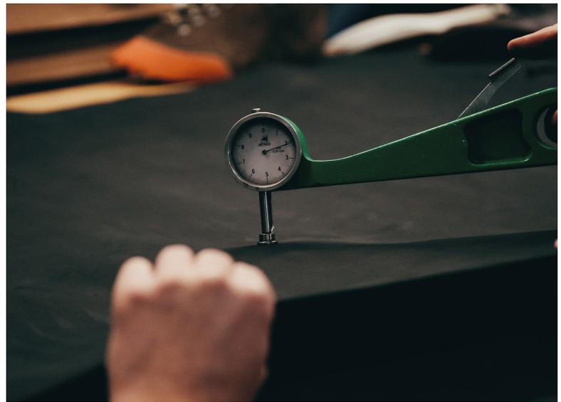
Die Lederstärke wird mit einem Spezialgerät gemessen – eine ungespaltene Rindschale hat eine Stärke von etwa 4,5 mm.
